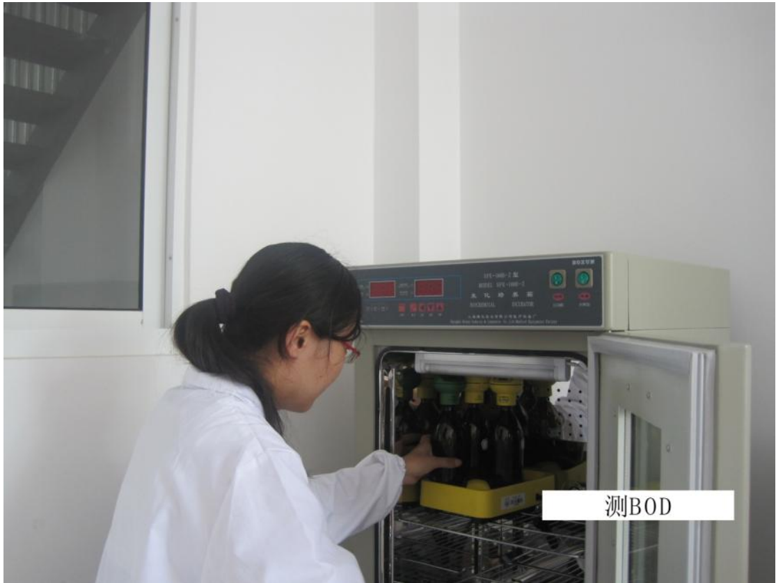
图 7-4 测 BOD 实验照片
