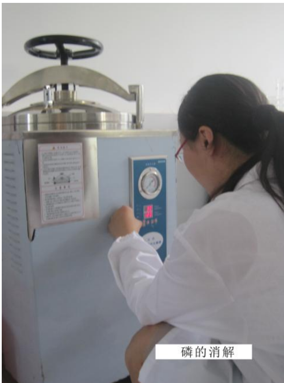
图 7-4 测总磷实验照片
